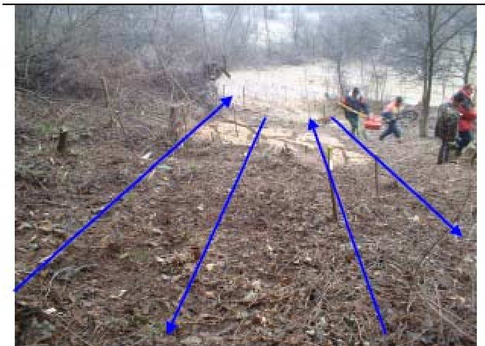
Sl.46 Kolci georadara radi oznaka nehomogenosti pod zemljom, Sjeverna strana Visočice. Preliminarni izvještaj - 1, LGA Bautechnik GmbH, Nuernberg. (Dr. Andreas Hasenstab, 12. februar 2006.)
