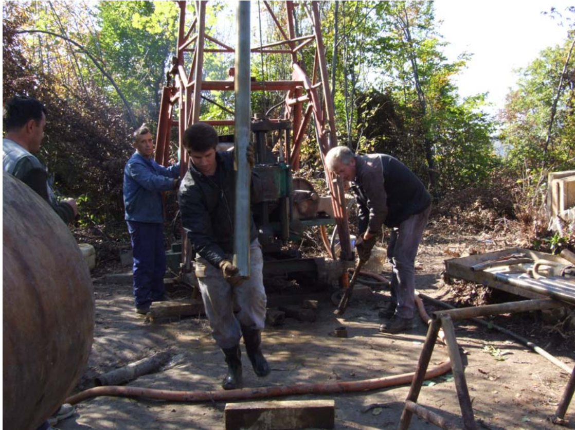
Sl. 15 Istražno bušenje na platou piramide Mjeseca. Vadenje uzoraka iz bušotine B-3 (Photo: Arhiv Fondacije AP BPS, oktobar 2006.)
